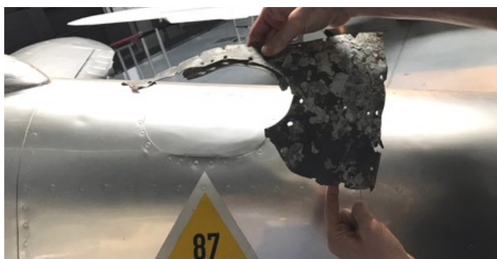
Trappe de maintenance et son emplacement sur le Me 109. Photo Gilles Collaveri
