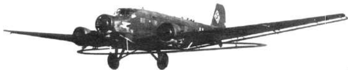
Junkers Ju-52 MS "Mausi". Au total, environ 70 Ju 52/3m ont été convertis en version "MinenSuch".
