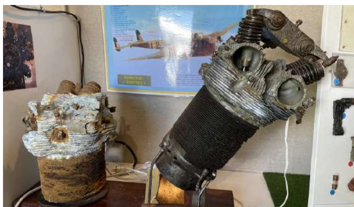
Des cylindres de moteur du Handley Page Hampden.
